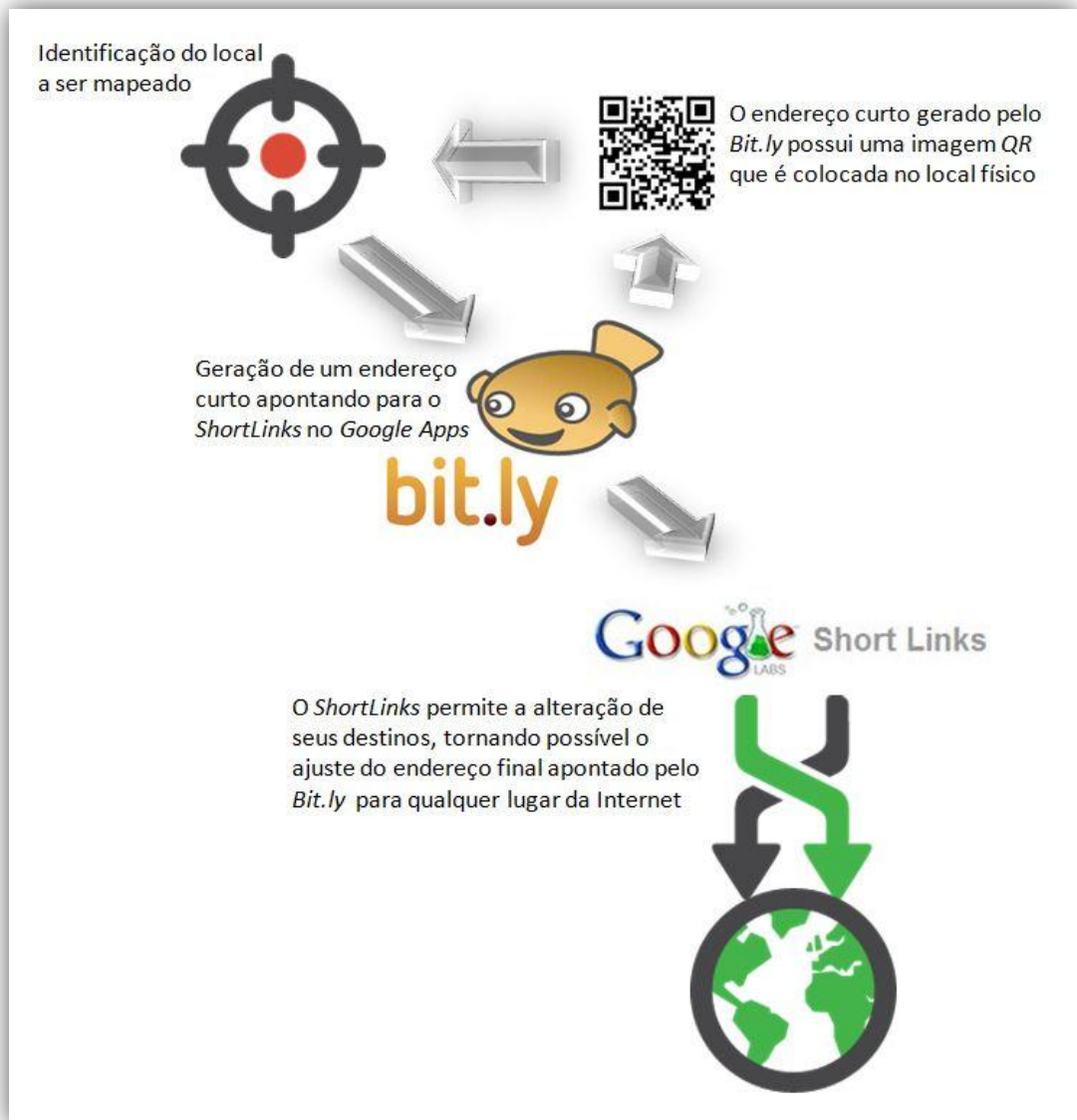
Figura 20: Arquitetura básica de mapeamento e direcionamento
