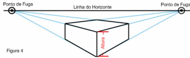
Figura 12: Cubo 3 - cubo em perspectiva de dois pontos de fuga
