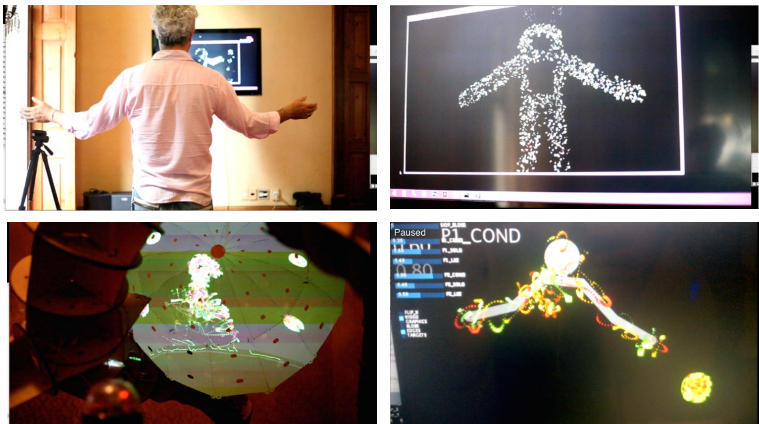
Fig. 13, 14, 15 e 16: Na sequência: captura do movimento pelo Kinect, criação e transmissão de avatar via rede, recepção e apresentação do modelo na telebiosfera.
